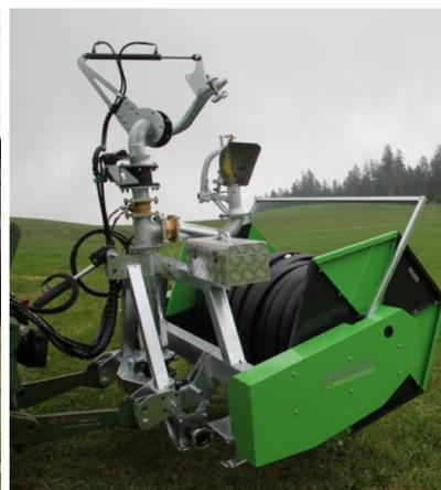
Die GHS kann bis zu 1000 m Schlauch fassen. Zudem verfügt sie über einen zusätzlichen Verteiler. Beide Einheiten lassen sich mit wenigen Handgriffen koppeln.
